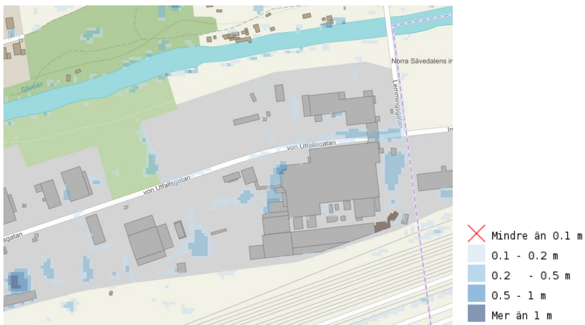
Befintlig översvämningssituation vid klimatanpassat 100-årsregn. Bild: stadsbyggnadsförvaltningen
