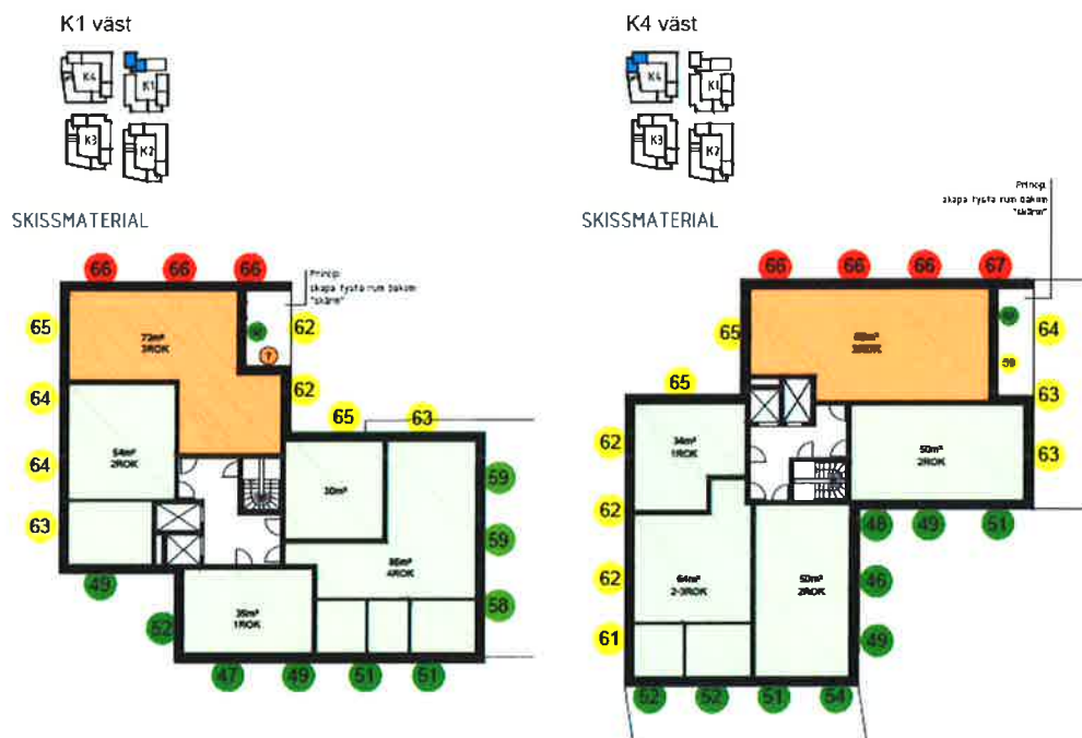
Illustration av trafikbuller i de högdelar som utsätts för trafikbuller från Oscarsleden/Älvsborgsbron. Förslag till lägenhetslösningar som kan ge bullerutsatta lägenheter (orange) möjlighet till skärmning som ger tillgång till ljuddämpad sida mot balkong.
