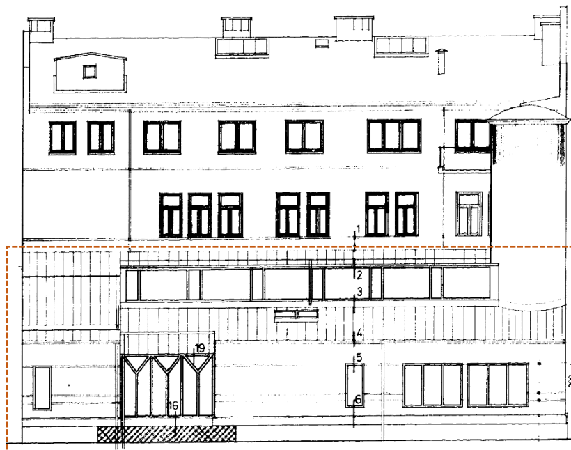
Tillbyggnadens fasad mot väster samt ursprunglig fasad plan 3 och påbyggnadens fasad plan 4. Balkongen på plan 3 revs och fönsterdörren byggdes om till fönster.
