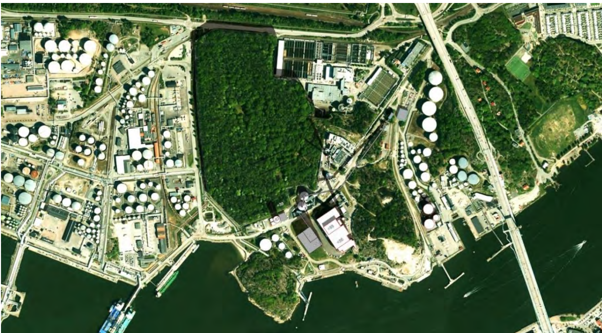
Figur 7.11 Skuggning kl. 12 den 20 mars. Ingen skuggning från planerad anläggning för bioångpanna når Rya skog. Bild från skuggutredningen (Göteborg Energi, 2020a).
