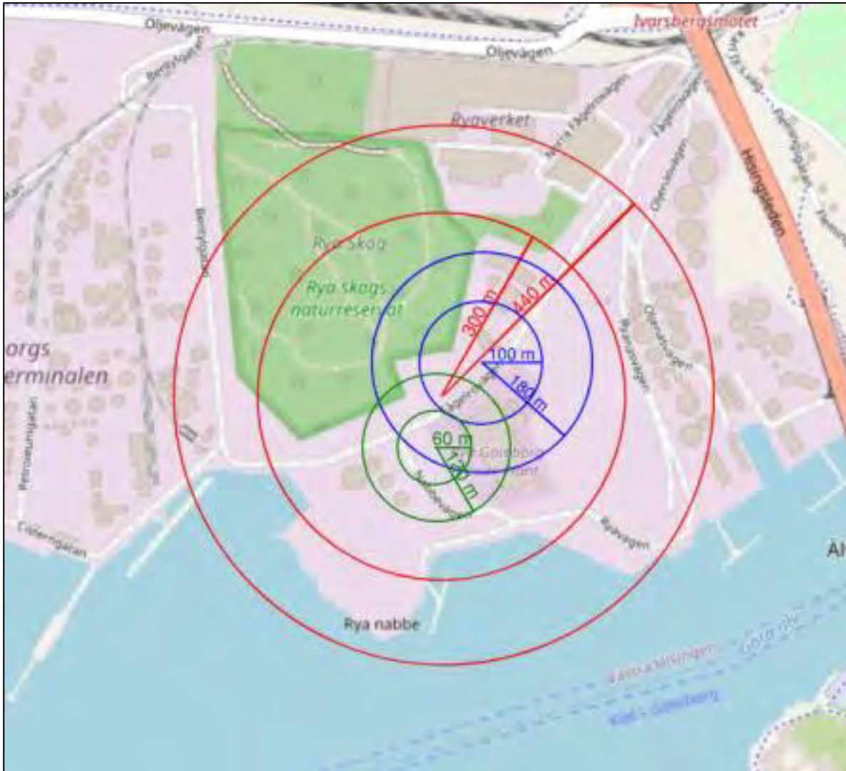
Figur 10.7. Maximalt teoretiskt avstånd för spridning av glödande partiklar vid brand i mottagning (blå cirklar), lagringssilor (röda cirklar) och dagssilor (gröna cirklar). De inre cirkelarna är vid en vindhastighet på 3 m/s och de yttre vid 8 m/s (Ramboll, 2021b).
