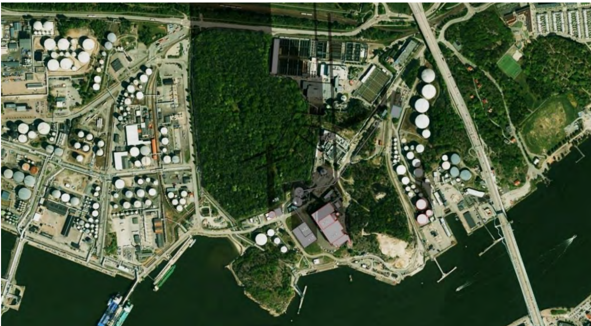
Figur 7.9 Skuggning kl. 12 den 21 december. Denna visar att Rya skog inte skuggas av någon del från den planerade bioångpannan vid detta tillfälle. De två runda silosbyggnaderna för bränsle nära Rya skog kommer troligtvis att ges en placering längre söderut, vilket innebär att inte heller dessa ger skuggning på någon del av skogen. Bild från skuggutredningen (Göteborg Energi, 2020a).
