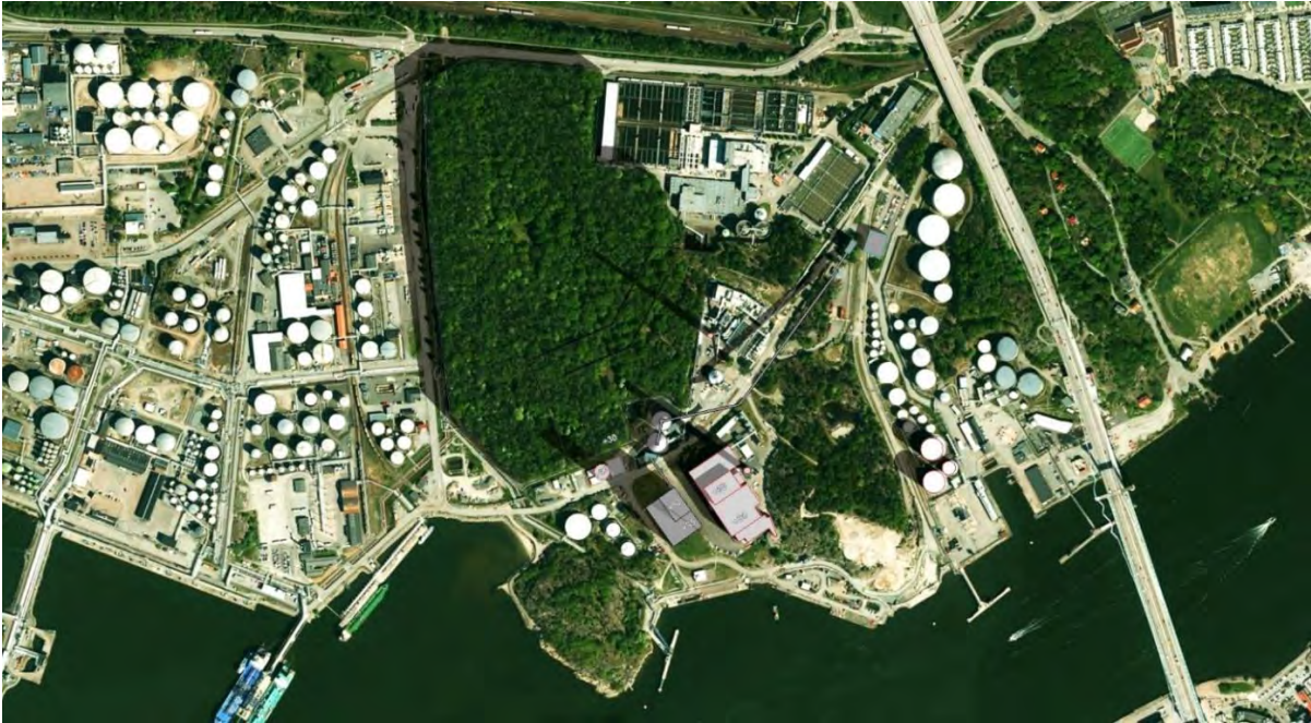
Figur 7.10 Skuggning kl. 10 den 20 mars. Vid denna tid på året står solen så högt att det på sin höjd är den allra sydligaste kanten av Rya skog som påverkas av skuggning från den planerade byggnaden för bioångpanna. De skuggpelare som når in i skogen som syns på bilden är från redan befintliga anläggningar. Bild från skuggutredningen (Göteborg Energi, 2020a).
