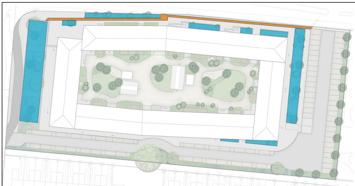
Figur 36. Föreslagna dagvattenlösningar inom planområdet med möjlig placering av regnbäddar i blått och skyfallsrännan i orangea.
