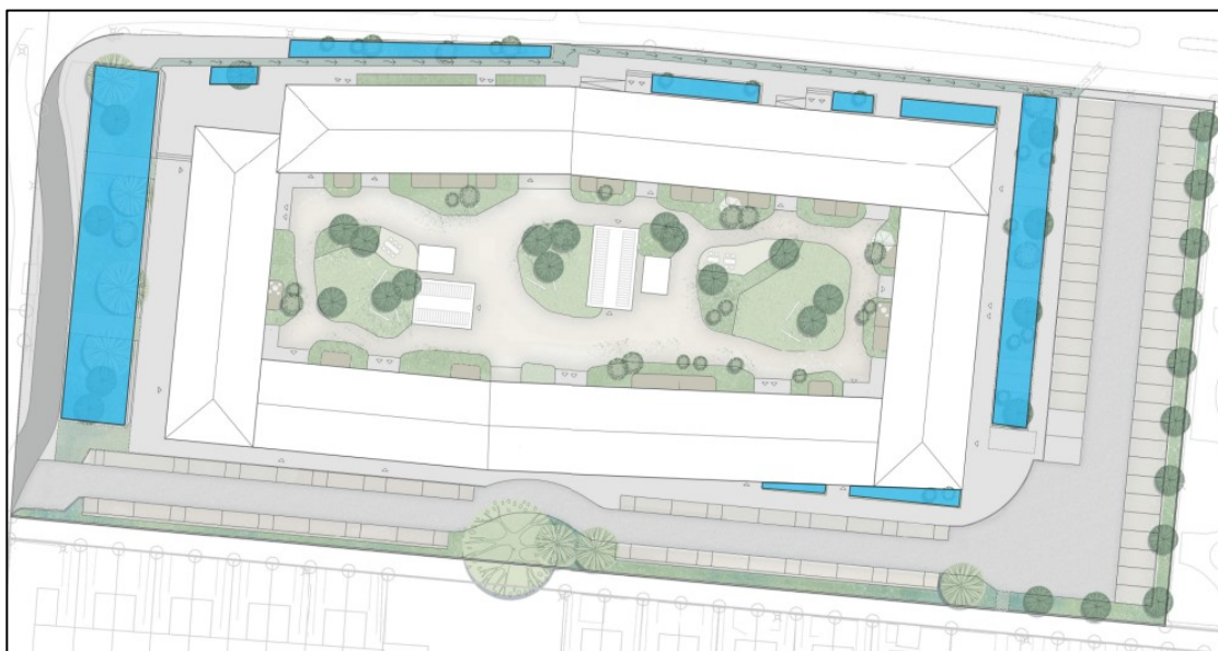
Figur 34. Möjliga placeringar för dagvattenhantering via regnbäddar/nedsänkta planteringsytor (utritade i blått i figur).
