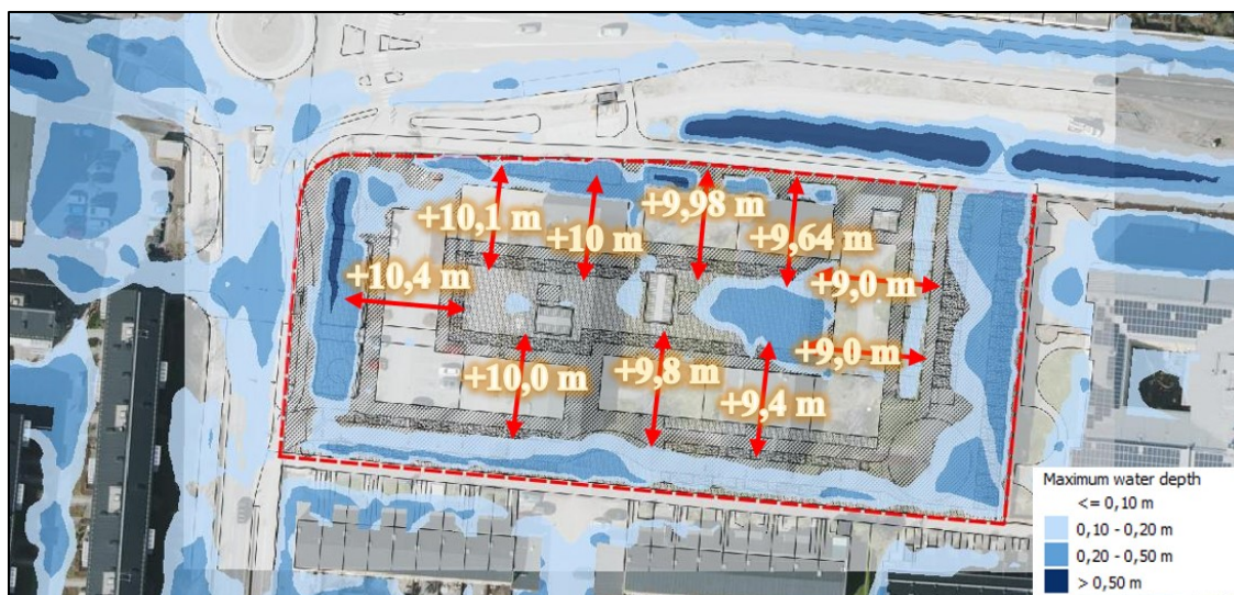
Figur 18. Lägsta golvnivåer för att uppnå en säkerhetsmarginal på 0,2 m över förväntad vattennivå vid byggnaderna.
