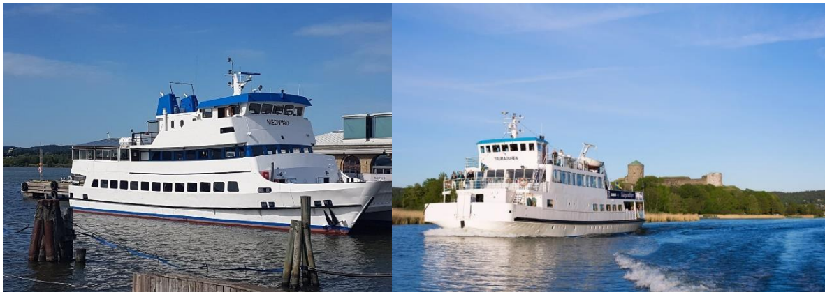
Figur 4:10. Bilder av fartyget Medvind med längd 31,34 meter, bredd 9,50 meter, djupgående 2,90 meter och höjd över vattenlinjen >12 meter samt fartyget Trubaduren med längd 30,34 meter, bredd 9,61 meter, djupgående 1,65 meter samt höjd över vattenlinjen >12 meter.
