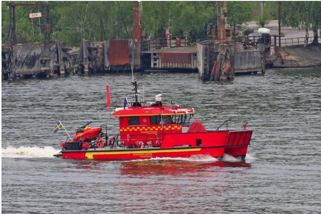
Figur 4:23. Bild av Räddningstjänsten Storgöteborgs fartyget Göte II med längd 15 meter och en höjd över vattenlinjen 5,55 meter. Bildkälla: lindhall.se .
