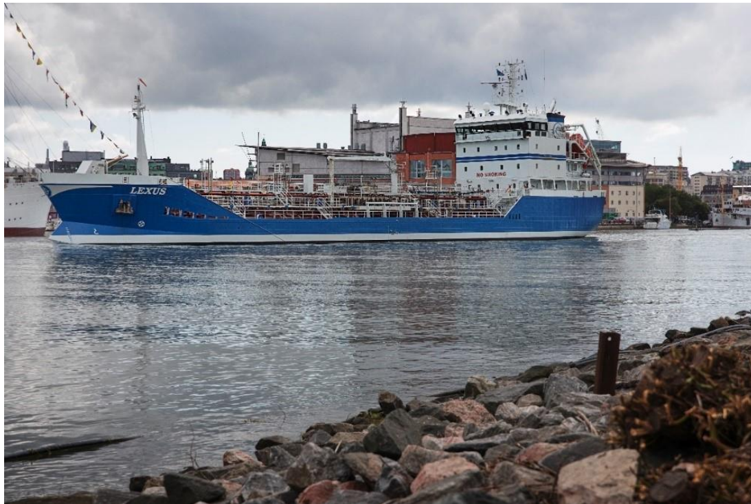
Figur 4.1. Bild av fartyget m/t Lexus med dimensionerna 88 meter lång och 13,4 meter bred, representerar ett Vänermax-fartyg, passerar Göteborgsoperan på väg uppströms.
