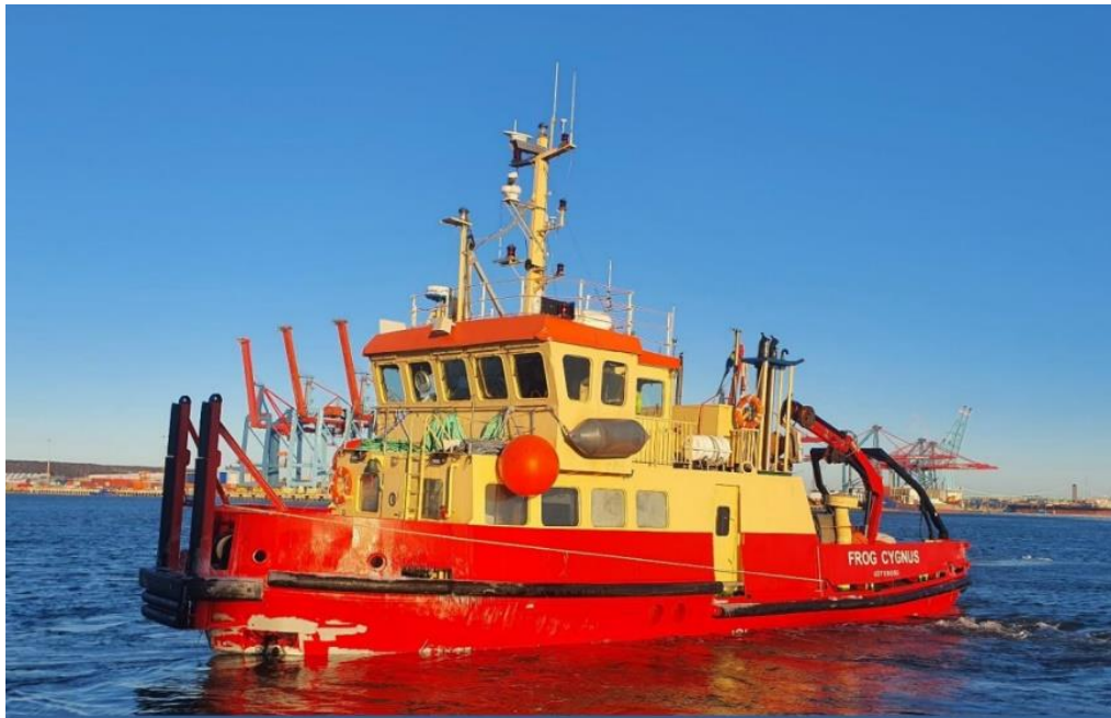
Figur 4:16. Bild av fartyget Frog Cygnus med dimensionerna längd 20,3 meter, bredd 6,05 meter och höjd över vattenlinjen >7 meter används bland annat till dykning och som bogserbåt. Bildkälla: sse-ab.se .
