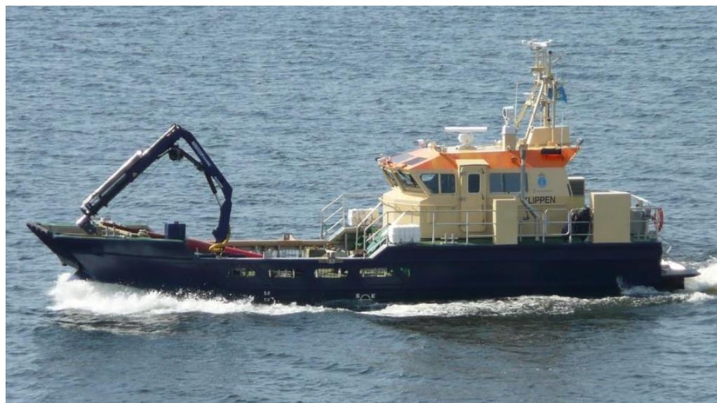
Figur 4:20. Bild av fartyget Klippen med dimensionerna längd 20 meter, bredd 6 meter samt höjd över vattenlinjen >7 meter, används till bland annat underhåll av farleder. Bildkälla: marinetraffic.com .
