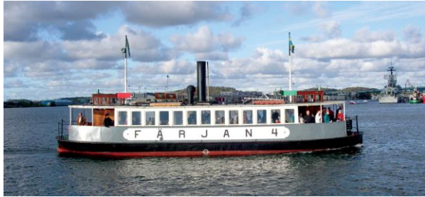
Figur 4:9. Bild av Färjan 4 med fartygsdimensionerna längd 20,55 meter, bredd 5,65 meter, djupgående 2,35 meter samt en msthöjd över vattenlinjen 8,5 meter. Bildkälla: sjofartsmuseetaktariet.se .
