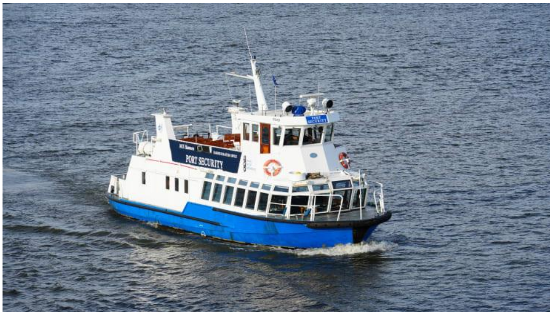
Figur 4:15. Bild av m/s Hamnen med fartygsdimensionerna längd 20,3 meter, bredd 5,7 meter och en höjd över vattenlinjen uppskattat >7 meter. Bildkälla: mynewsdesk.com/se/goteborgs-hamn/ .
