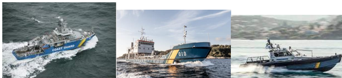
Figur 4:19. Bilder av exempel på Kustbevakningens fartyg från vänster till höger KBV 001, KBV 010 samt KBV 476 med dimensionerna LxBxH: 81,2x16,2x32 meter, 46,1x8,6x19,5 meter samt 12x4x5 meter.
