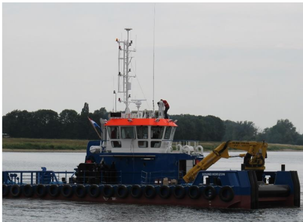
Figur 4:17. Bild av fartyget Sound Horizon med dimensionerna längd cirka 24 meter, bredd 9,5 meter och höjd över vattenlinjen 15 meter eller 8,25 meter med masten fälld, kan nyttjas till en stor mängd olika uppdrag. Bildkälla: sse-ab.se .
