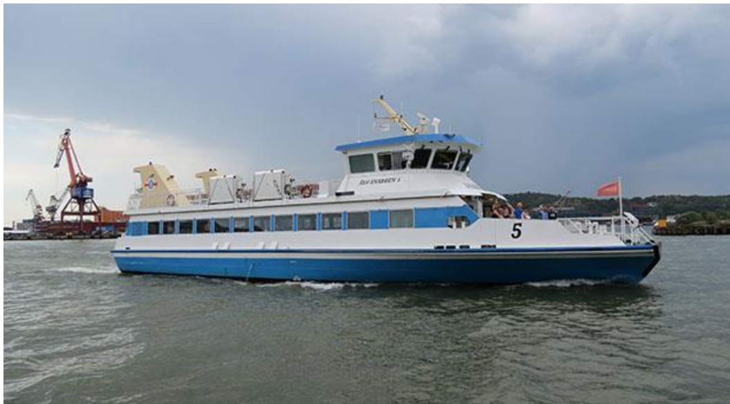
Figur 4:5. Bild av fartyget Älvsnabben 5 trafikerar sträckan Älvsnabben. Fartygsdimensioner: längd 32 meter, bredd 8,2 meter, höjd över vattenlinjen cirka 10 meter samt displacement cirka 150 ton. Bildkälla: styrsobolaget.se .
