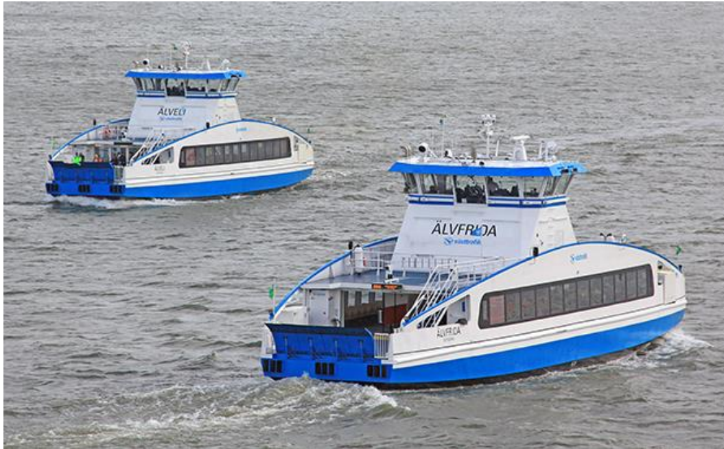
Figur 4:4. Bild av fartygen Älveli och Älvfrida trafikerar sträckan Älvsnabbare (linje 286). De har dimensionerna längd 33 meter, bredd 8,7 meter, höjd över vattenlinjen 12,9 meter samt displacement 172 ton. Bildkälla: styrsobolaget.se .
