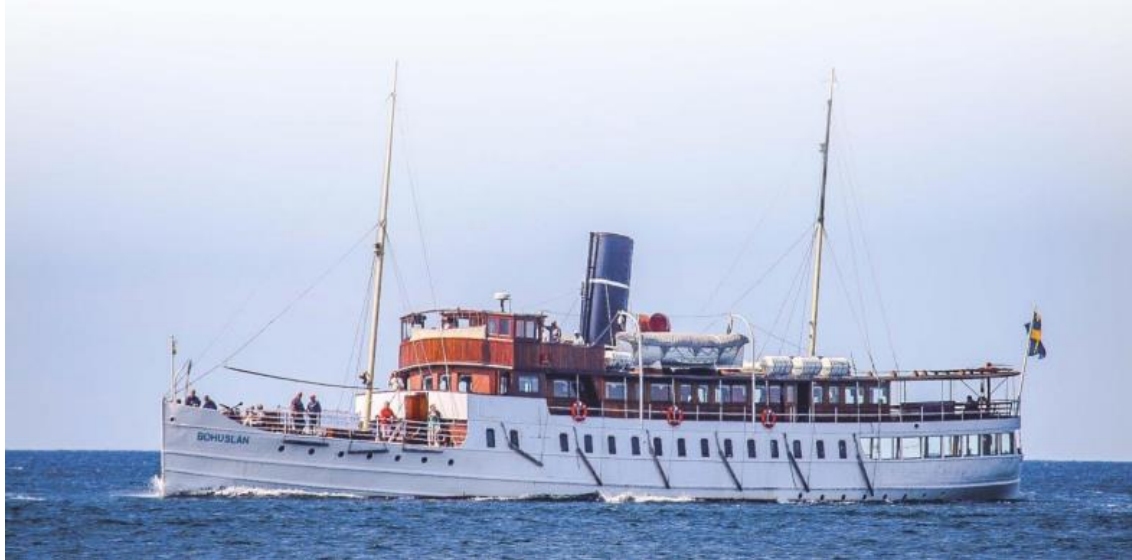
Figur 4:7. Bild av Ångaren Bohuslän med fartygsdimensioner: längd 43,13 meter, bredd 7,42 meter, djupgående 3,0 meter samt masthöjd över vattenlinjen 18 meter. Bildkälla: steamboat.se .
