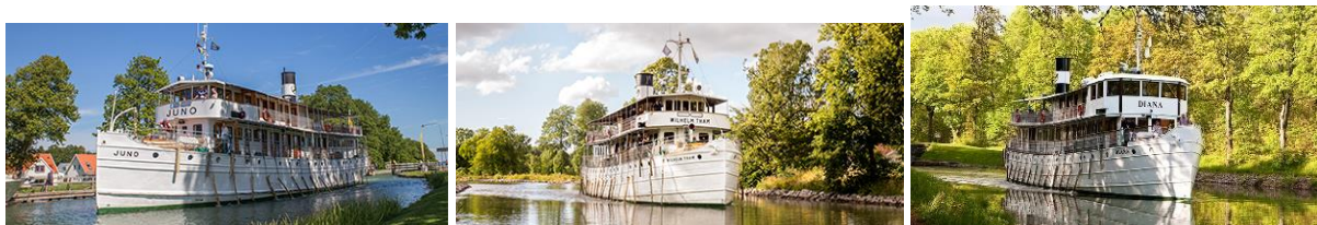
Figur 4:11. Bilder av fartygen Juno, Wilhelm Tham och Diana har snarlika dimensioner med längd cirka 31,5 meter, bredd cirka 6,8 meter och höjd över vattenlinjen >10 meter. Bildkälla: gotacanal.se .
