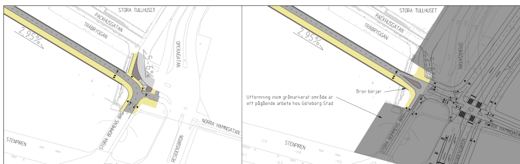
Figur 61 Möjliga principskisser för brons anslutning vid Packhuskajen och anslutning till tillfällig lösning till vänster och till en lösning med kommande Boulevard till höger (Sweco, 2024).
