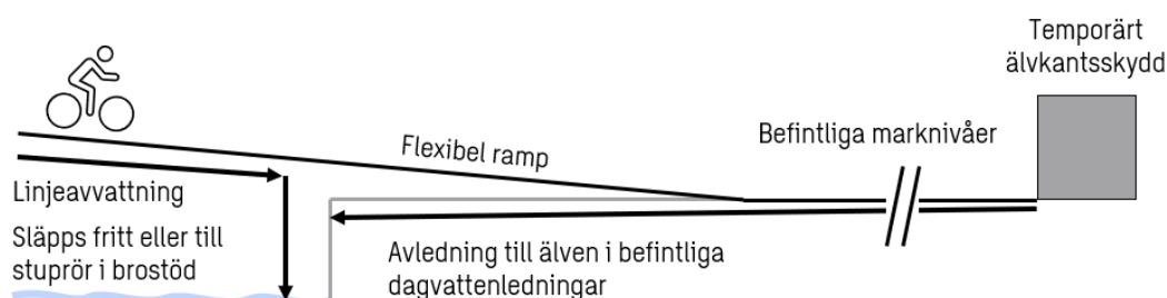
Figur 68 Avledning från bron in anordnas med linjeavvattning som avleds via stuprör till Göta älv. Ramp eller befintlig kaj avvattnas till befintligt dagvattensystem
