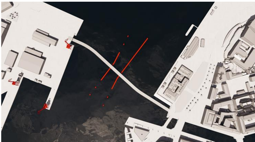
Figur 52 Illustration, med en möjlig lösning för bro och ledverk (påseglingsskydd) inom detaljplanen (Sweco 2024)
