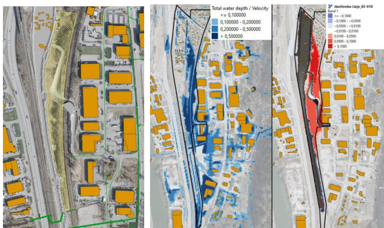
Figur 8. Den vänstra bilden visar det område i södra delen av planområdet, som schaktas ur och anläggs som fördröjningsyta. Den centrala samt högra bilden visar framtida översvämningssituation till följd av exploateringen. Centralt visas var vattendjupet förväntas minska (i blått) respektive öka (i rött) när fördröjningsytan anlagts.
