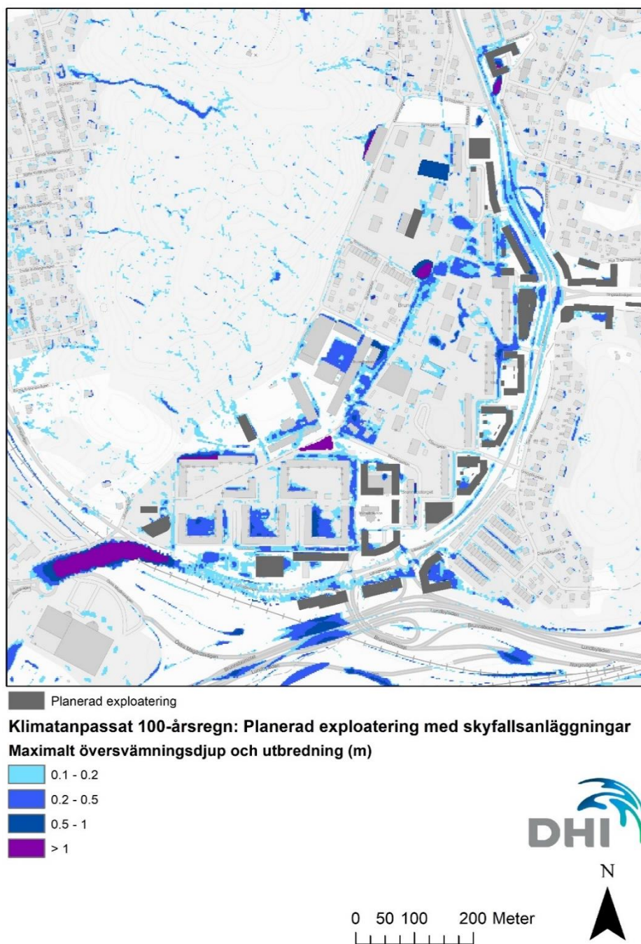
Figur 20 Maximalt översvämningsdjup vid planerad exploatering med rekommenderade skyfallsanläggningar
