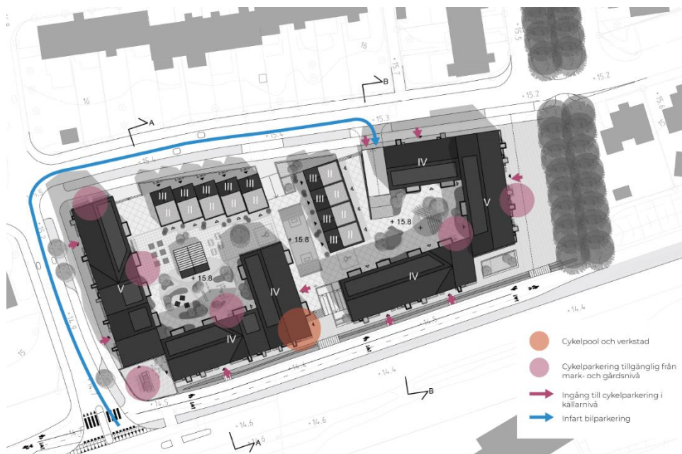
Figur 20. Översikt över parkeringslösning (AL Studio, februari 2023)
